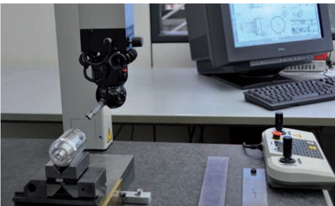
Kontrola rdzenia pompy hydraulicznej przez urządzenie 3D
